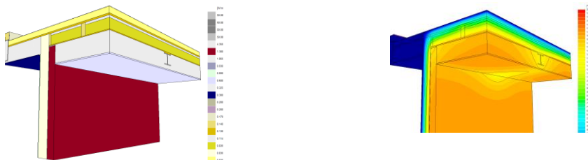
Afbeelding 2 – Schematische weergave van een dakrandoverstek met koudebrug (links) met bijbehorende temperatuurlijnen (rechts)
